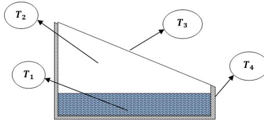
T1- Seawater temperature (°C), T2- Room temperature (°C), T3- Glass surface temperature (°C), T4- Environmental temperature (°C)
